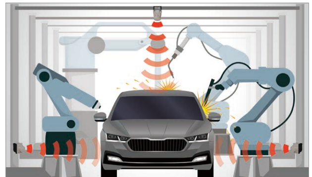
自動車 機械 金属 製品距離検知(材質・形状・色の影響をうけにくい) スポットでなく、面での安定距離検知
